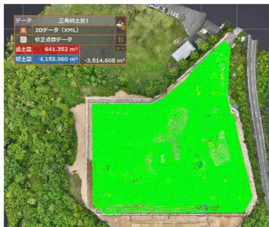
図 1-2-6 点群と点群の差分解析
