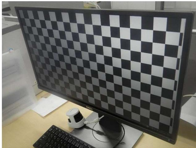
図 3-3-16 モニター利用によるキャリブレーション
