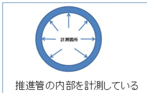
図 4-8 推進管断面 計測箇所
