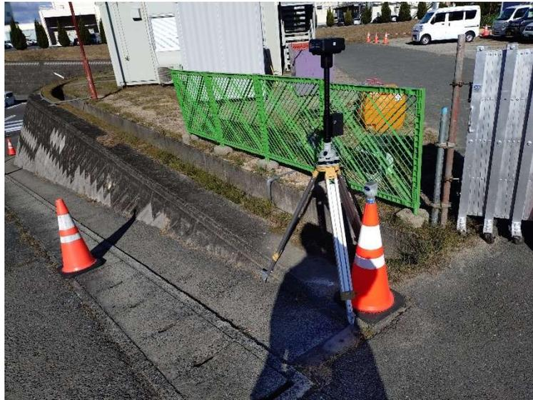
図 1-2-19 ドローン専用 RTK 固定局
