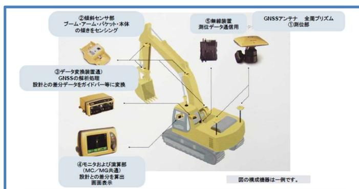
図 1-2-52 マシンガイダンス搭載システム
