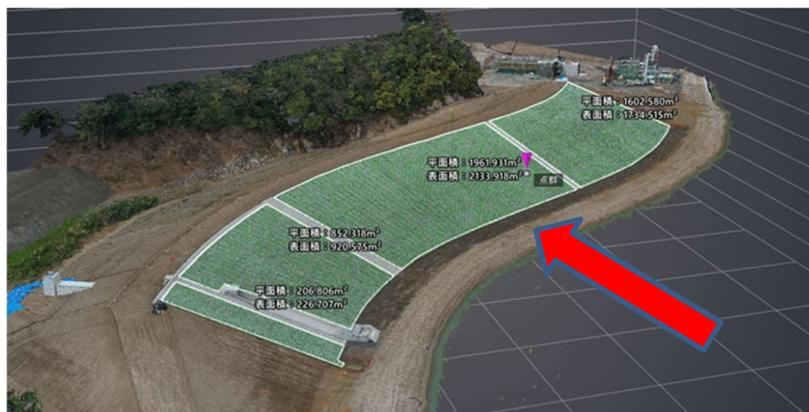
図 3-3-1 河川堤防法面の 3 次元設計データ
