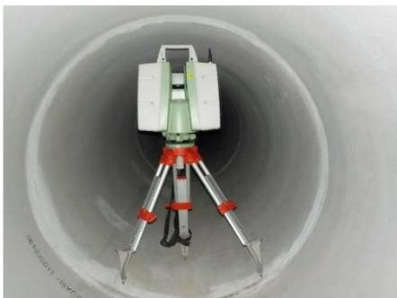
図 4-3 地上設置型レーザースキャナー
