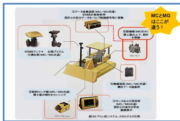
図 1-2-53 ICT 機器取付ブルドーザ
