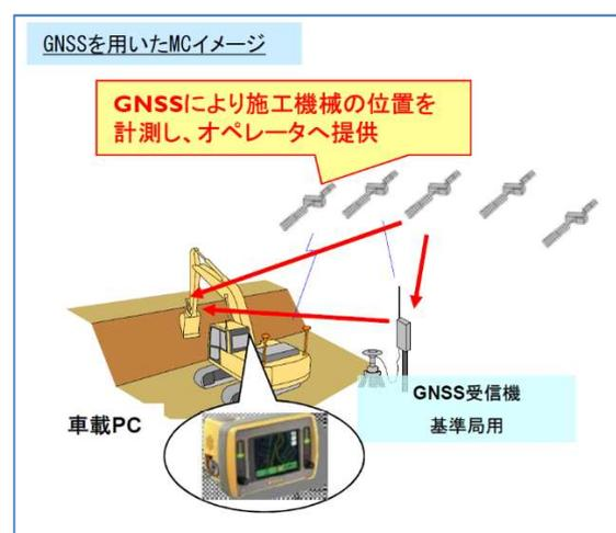
図 1-2-50 RTK-GNSS イメージ
