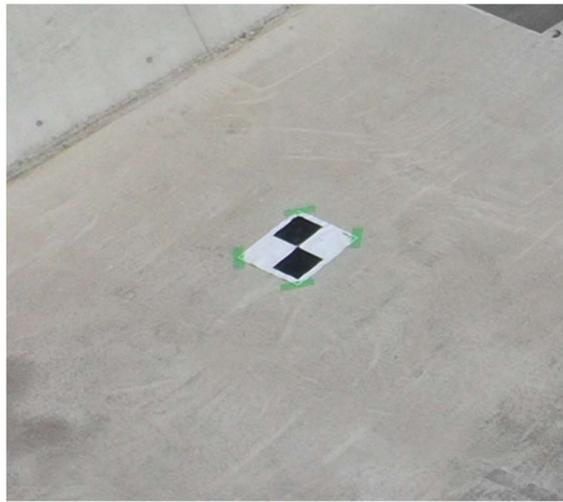
図 1-2-17 対空標識設置事例
