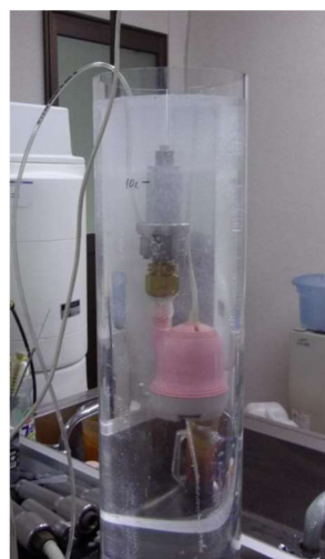
写真 3-3 スケール重量 測定室内試験装置
