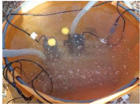
写真 6-3 周辺地下水を用いて生成したマイクロ・ナノバブル
