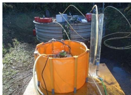
写真 5-4 タンク, CO 2 ボンベ, 先端照射部等
