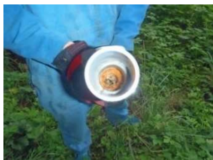
写真 2-1 排水量計量部のスライム（設置 1 カ月後）
