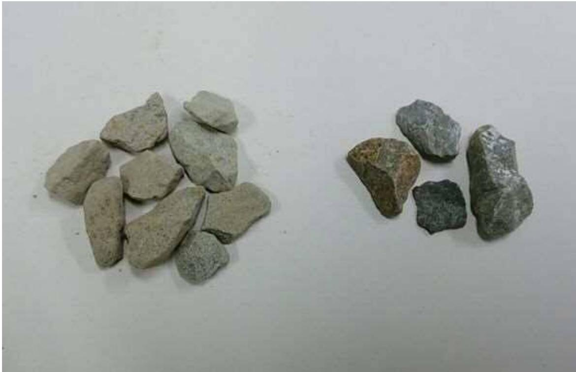
図 2.7-2 ノロが付着している粗骨材（左）と水洗した粗骨材（右）
