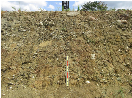
写真 1-3 亜円～亜角礫主体で淘汰不良, 基質が多い. (賀陽北かよう道の駅東側法面)
