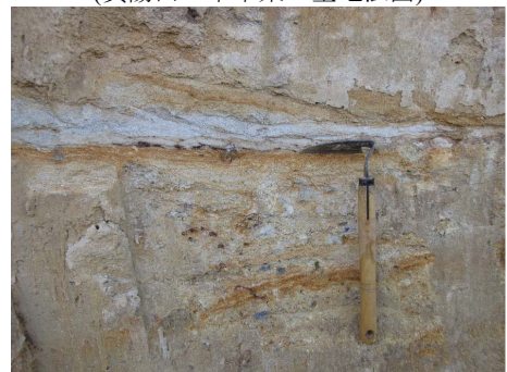
写真 2-4 粗粒砂岩層内の斜交葉理が発達する細粒砂岩. (賀陽西湯原下の圃場整備道路法面)
