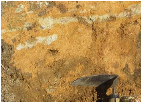
写真 14-1 淘汰は良く塊状である，白色部は風化による。 写真 14-2 強風化により赤色化し網目状模様を形成。 (賀陽北かよう道の駅東 180m 町道横法面露頭) (吉備高原都市吉川阿波良公営住宅北の道路法面露頭)
