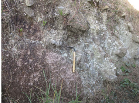
写真 1-1 亜角礫主体で基質支持, 「クサリ礫」化. (高梁市檜井檜井工業団地北端)
