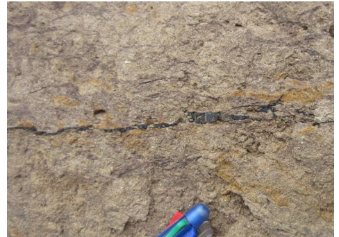
写真 15-4 塊状で生痕が多く石炭化した植物片を含む。 (賀陽西岡山道賀陽 IC 南西 600m 国道 484 号横法面露頭)
