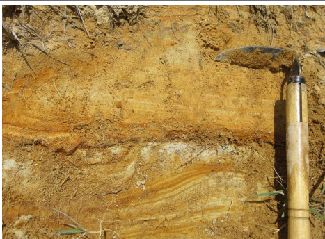
写真 10-2 平行葉理を切るリーゼガンク模様が認められる。 (吉備高原都市吉川阿波良の圃場整備法面の露頭)
