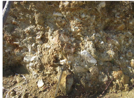
写真 3-2 亜円礫主体で淘汰中程度,礫支持, 基質粗粒砂。 (賀陽西西山 新規開析谷沿いの露頭)
