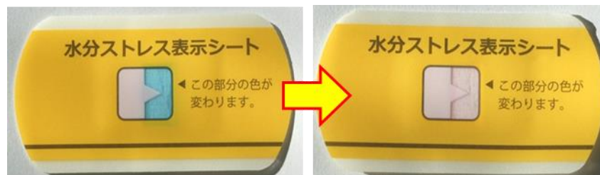
第 2-2-6 図 水分ストレス表示シートの外観（左：変色前，右：変色後）
