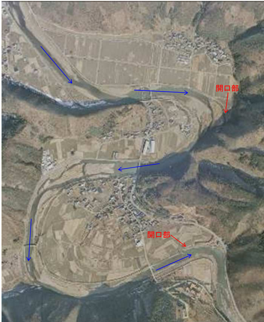
図 3.2-13 佐用川の開口部（図 3.2-12 の約 7km 下流地点の開口部）
