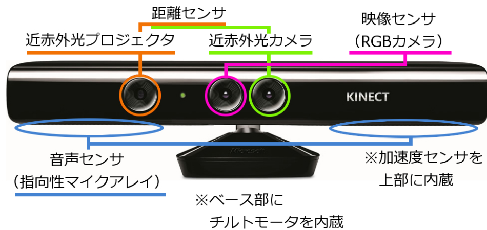
図 3.2: Kinect for Windows センサの構成
