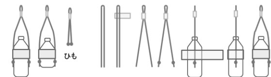
カラーロープ約50cm(40cm)を二つに折り、ビニルテープを巻き、ロープの端に作った結び目を滑り止めにして、梱包用テープでペットボトルに止める。
