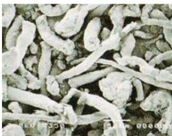
Figure 10 L-HPC (LH-21 グレード) 粉末の電子顕微鏡写真<sup>59)</sup>より引用
