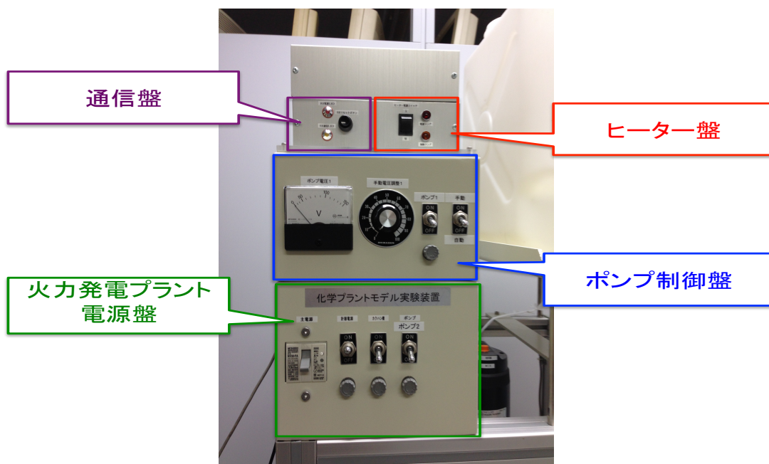
図5-9 模擬火力発電プラント本体の各制御盤関係詳細説明図
