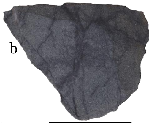
Figure 6. a, 厚さ 60cm の級化構造をなす砂岩単層。上部の粗粒～中粒砂岩に平行葉理が形成されている。下部の粗粒砂岩にはスランプ状に変形したリップアップクラストを含む。b, 砂岩中に泥が網目状に注入している。(スケールバーは 5cm)
