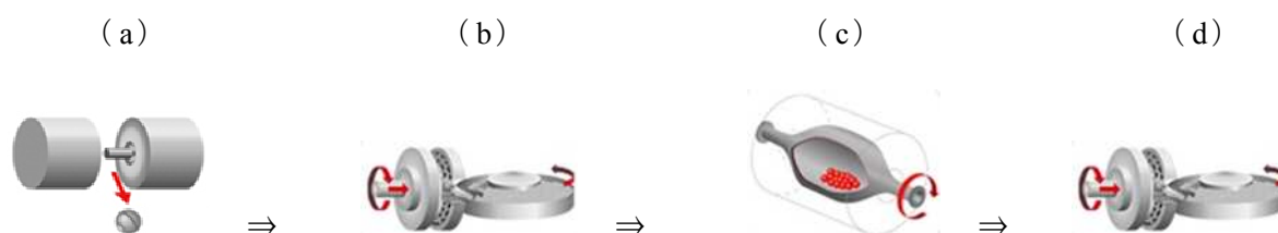
図 2-2 一般的な鋼球の製造工程
