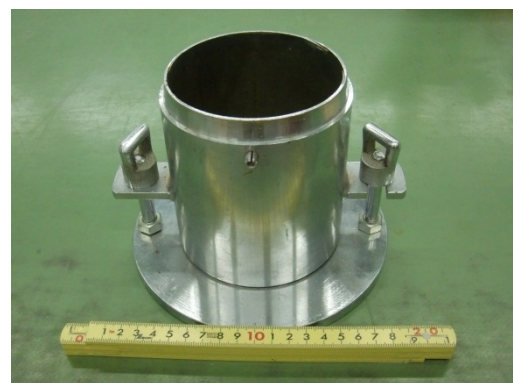
図 5.2-2 充てん実験に用いた小型容器
