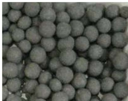
図 3.3-6 転動造粒後の球形ペレット
