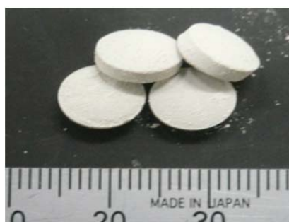
図 3.2-4 打錠法で製造されたベントナイトペレット
