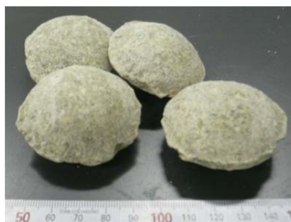
図 3.2-3 ブリケッティング法で製造されたベントナイトペレット
