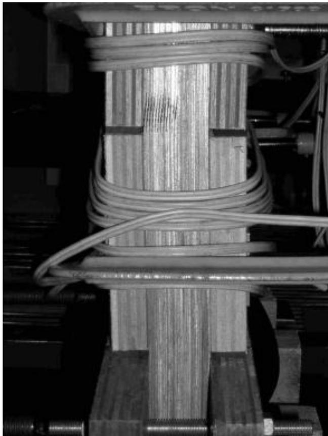
図 3.10 圧縮応力によって変形した鉄心脚（側面から撮影）
