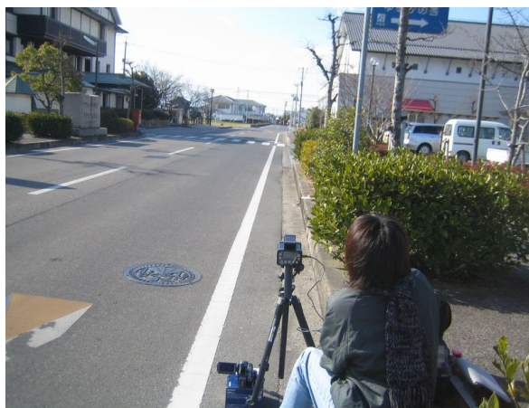
図 3-1 スピードガンによる計測の状況
