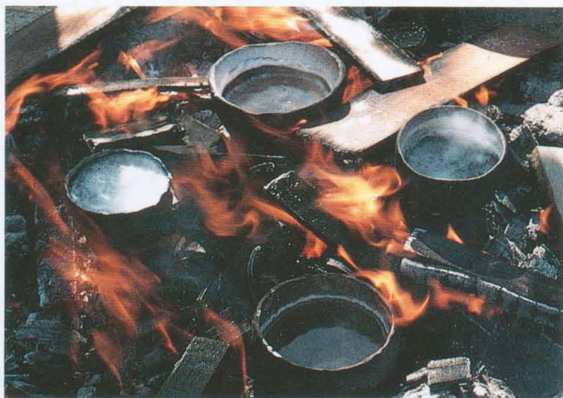
塩を作る実験 濃くした海水（かん水）を根気よく煮つめていく。熱気とのたたかいだ。かん水をどのようにして作っていたかはまだはっきりわかっていない。
