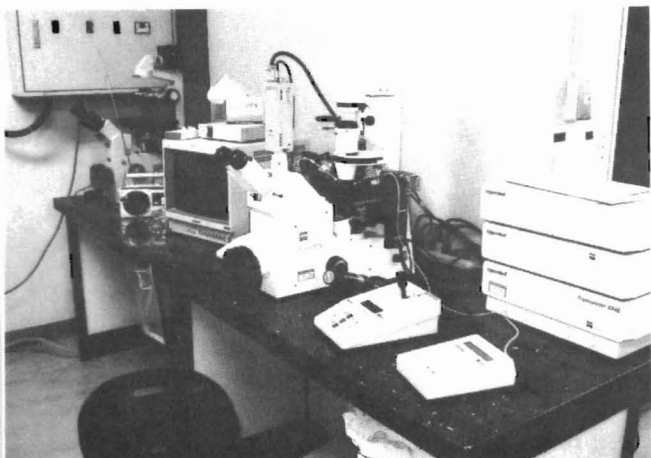
図6 トランスジェニック、ノックアウト動物作成のためのマイクロインジェクターである。コンピューターで操作可能なインジェクターが二式設備されている。ここではすでに数百系統のマウスが作成された。
