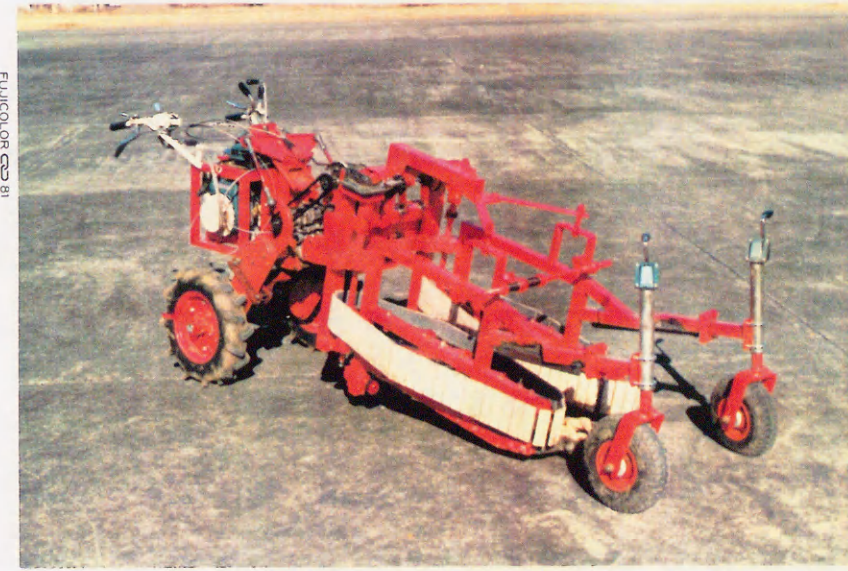
写真11 改良後の引抜き・搬送機構概観
