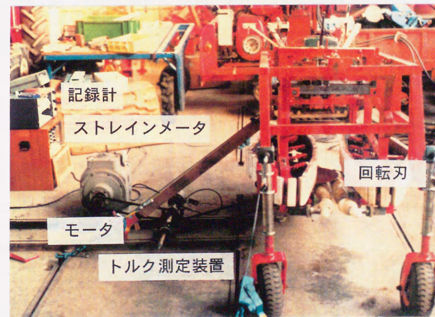
写真15 ハクサイ根茎部切断トルク測定装置
