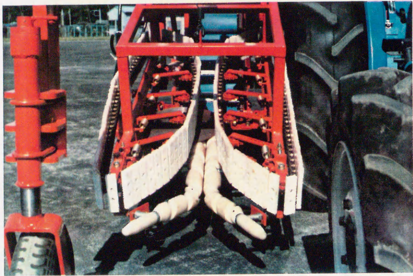
写真25 スクリューオーガと挟持ベルトの概観
